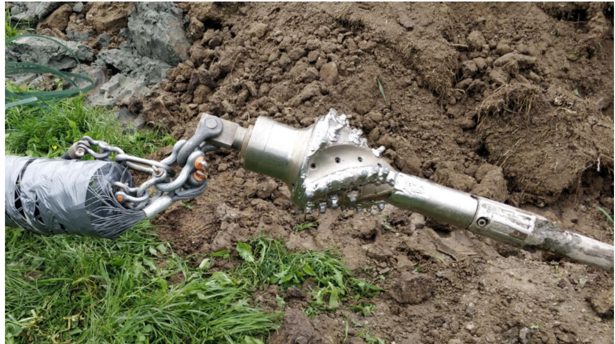
Grabenlose Verlegung im günstigen Spülbohrverfahren
